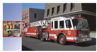
Кабельный барабан GIFAS для использования в спасательных и спец. автомобилях. Изготовлен в соответствии с требованиями DIN 14555-3: 2002 – 06
